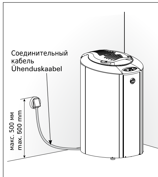
Рис. 10. Установка каменки Joonis 10. Kerise ühendamise
